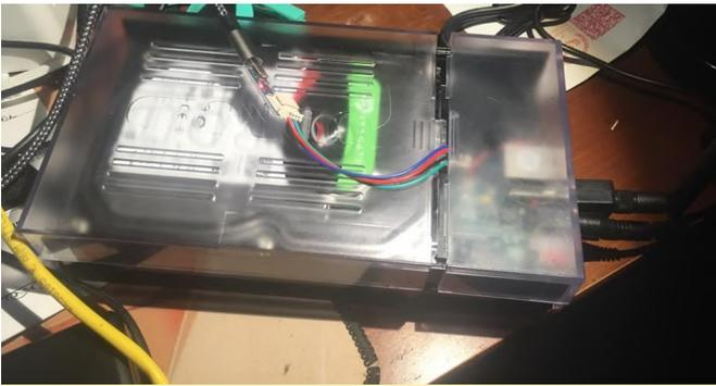
**Figura 3: ODROID-HC2 trabajando sobre mi mesa de escritorio con el kit de conexión UART**
