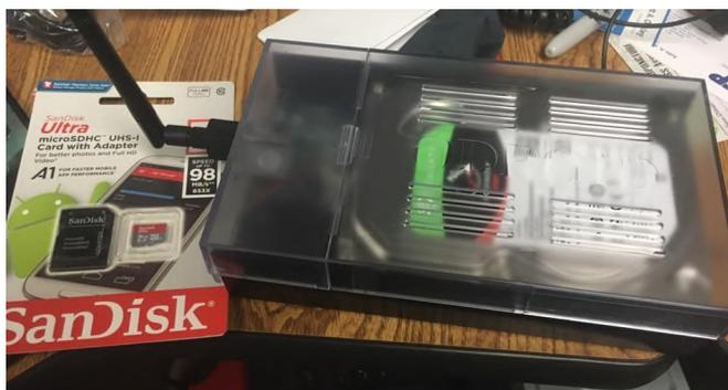
**Figura 2: ODROID-HC2 dentro de una carcasa acrílica transparente con el NIC inalámbrica conectado, y una tarjeta flash de 16GB antes de grabarle el SO Ubuntu 18.04.1**
