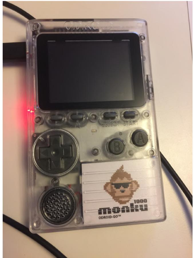
**Figura 13 - Comprueba la luz roja para ver si está completamente cargado**
