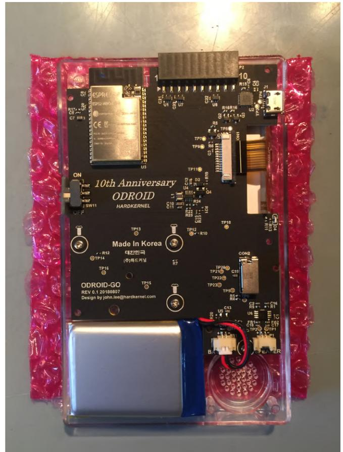
**Figura 8 - Ejemplo de cómo colocar la batería**
