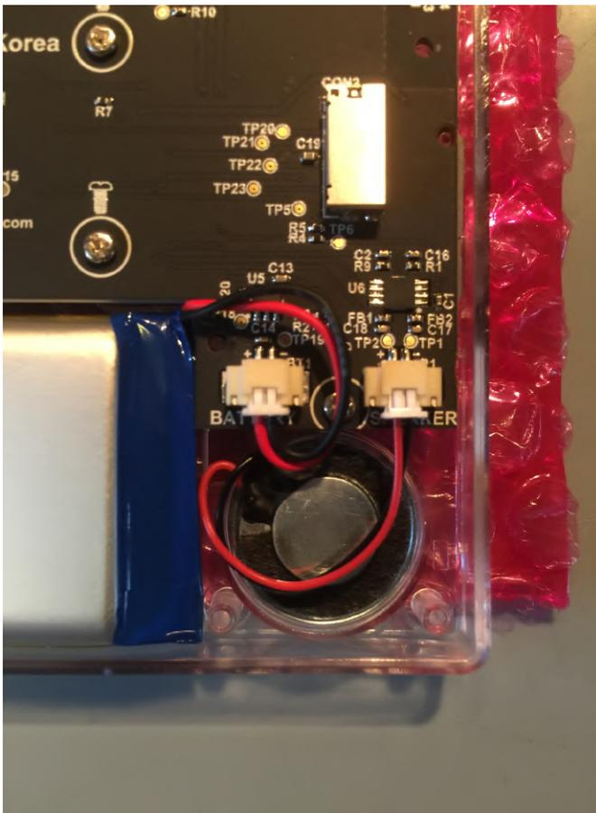
**Figura 9: Observa como la batería y los conectores de los altavoces están firmemente colocados en su lugar y tocan la parte posterior de la ranura de conexión**
