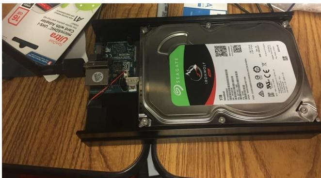
**Figura 1: ODROID-HC2 con batería RTC, disco duro Seagate Iron Wolf de 1TB y NIC Wifi modelo 3**
