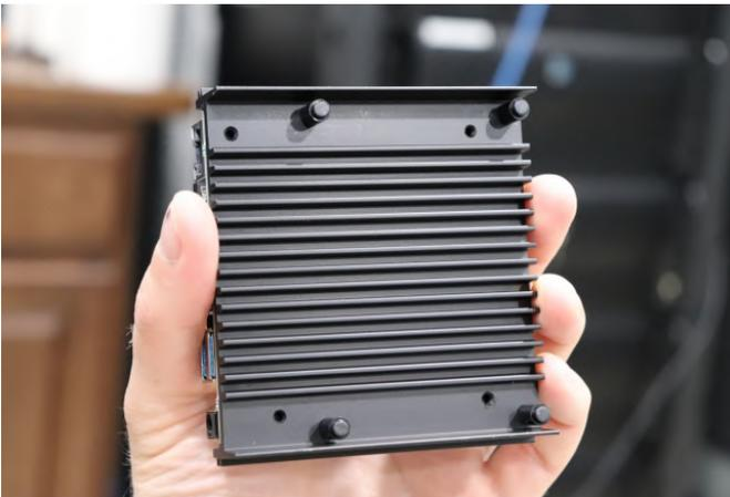
**Figura 3 - Vista del fondo y del disipador de calor.**
