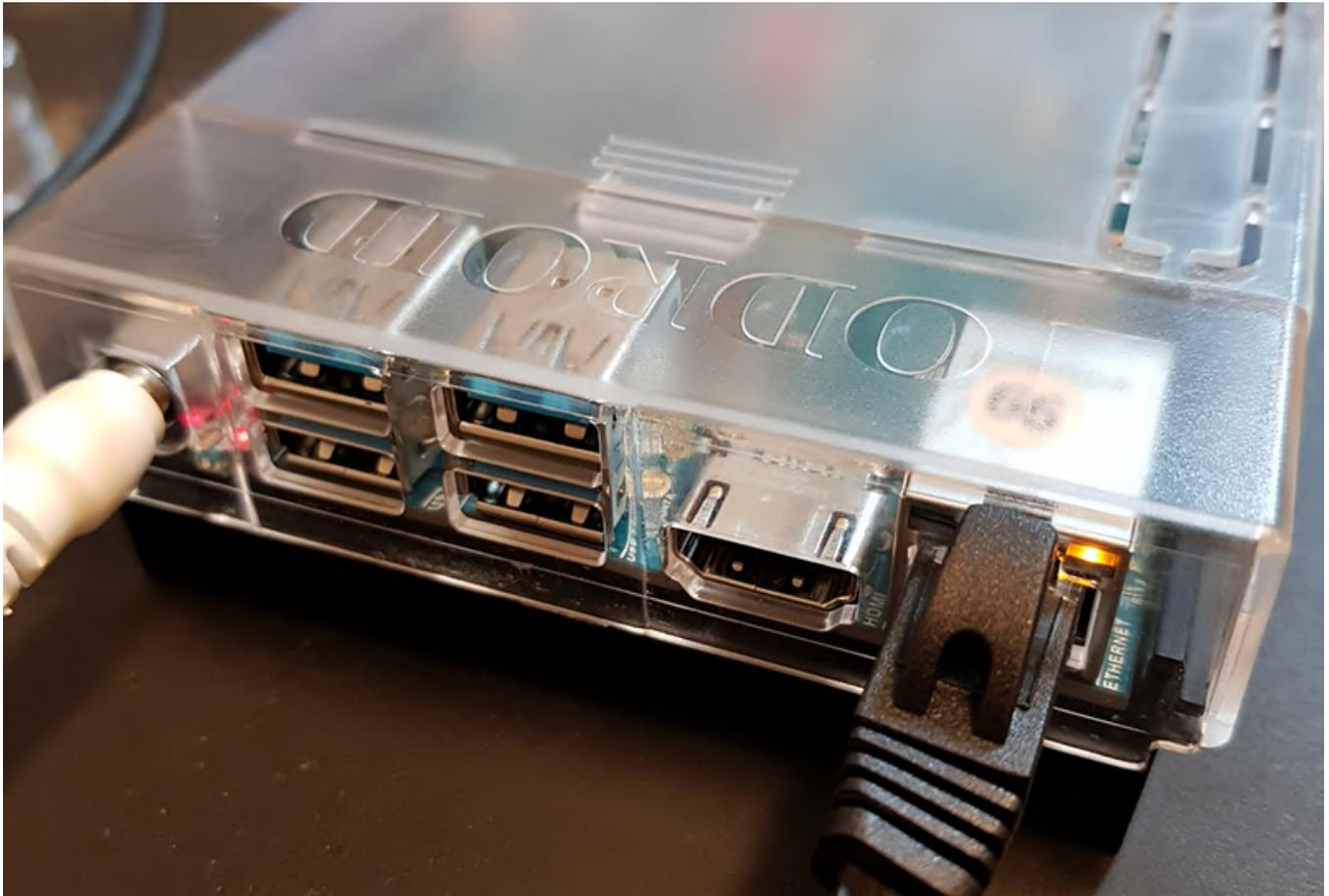
Hace poco recibí de Hardkernel un ODROID-N2, una nueva placa que reemplaza al ODROID-N1 cancelado. Dentro del paquete, encontré la placa ODROID-N2, la fuente de alimentación, la carcasa transparente, el adaptador USB WiFi y una tarjeta eMMC de 32 GB. El Modulo eMMC es mucho más rápido que las tarjetas SD.
