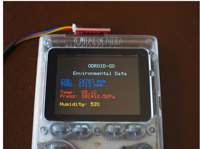
**Figura 3 - Un resultado de muestra del Qwiic Environmental Combo Breakout.**
