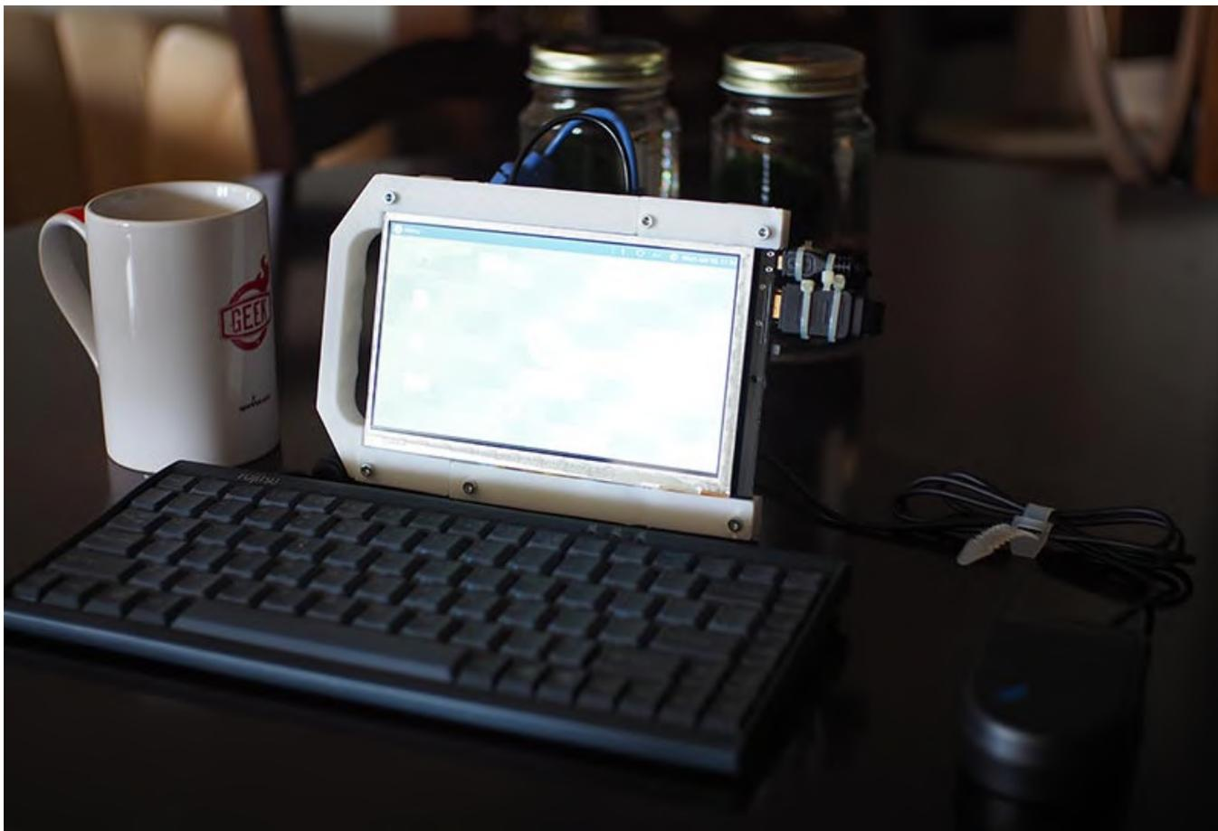
Oculto a simple vista en forma del potente ordenador de placa reducida de Hardkernel (SBC), el modesto ODROID-C0. Ligeramente más grande que una batería de 3.000 mAh pero impulsado por un Amlogic S805 System-on-a-Chip (SoC) que consume 1 Gb de RAM, dos puertos USB (2.0), una interfaz eMMC y un zócalo para tarjeta de almacenamiento microSD, Este SBC es el secreto mejor guardado del mundo ODROID.
