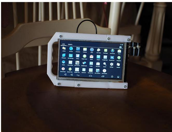
**Figura 2: Cambiar el jumper J1 convierte la tablet ODROID en un dispositivo portátil Android 4.4.4.**
