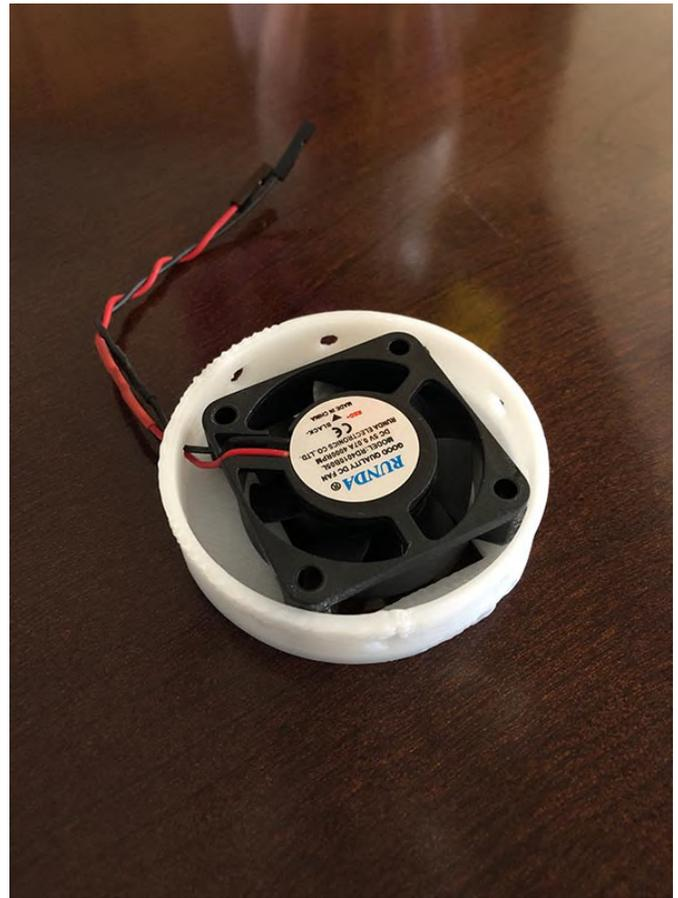
**Figura 5: el ventilador USB opcional ahora se puede conectar a los pines de alimentación GPIO 5V.**
