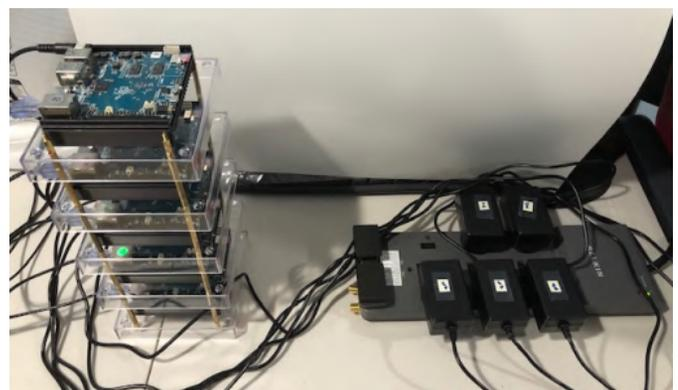
**Figura 10: Cables Ethernet conectados al clúster**
