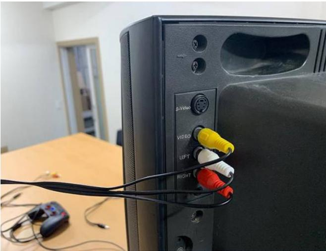
Figura 3: Conexión de TV con cables RCA macho a macho
