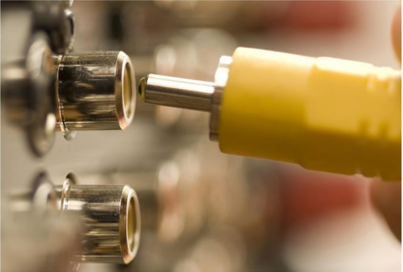
El video compuesto es un sistema de transmisión de vídeo analógico que fue muy popular antes de la era de la televisión digital, con resoluciones compatibles 480i y 576i. El ODROID-N2 admite esta función de vídeo y está diseñado para conectarse a un televisor a través de su conector de audio.
