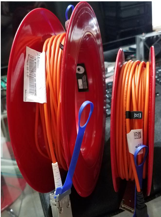
**Figura 16: Usando carrete de plástico para almacenar cables AOC**
