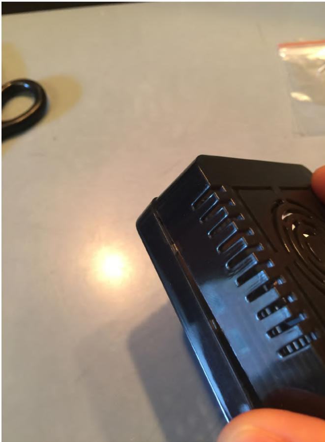
**Figura 5 - Primer plano de los clips en el lateral de la carcasa**
