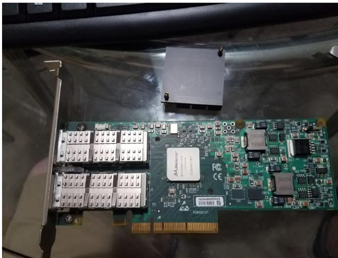
**Figura 18 - Disipador térmico e IC limpiados**
