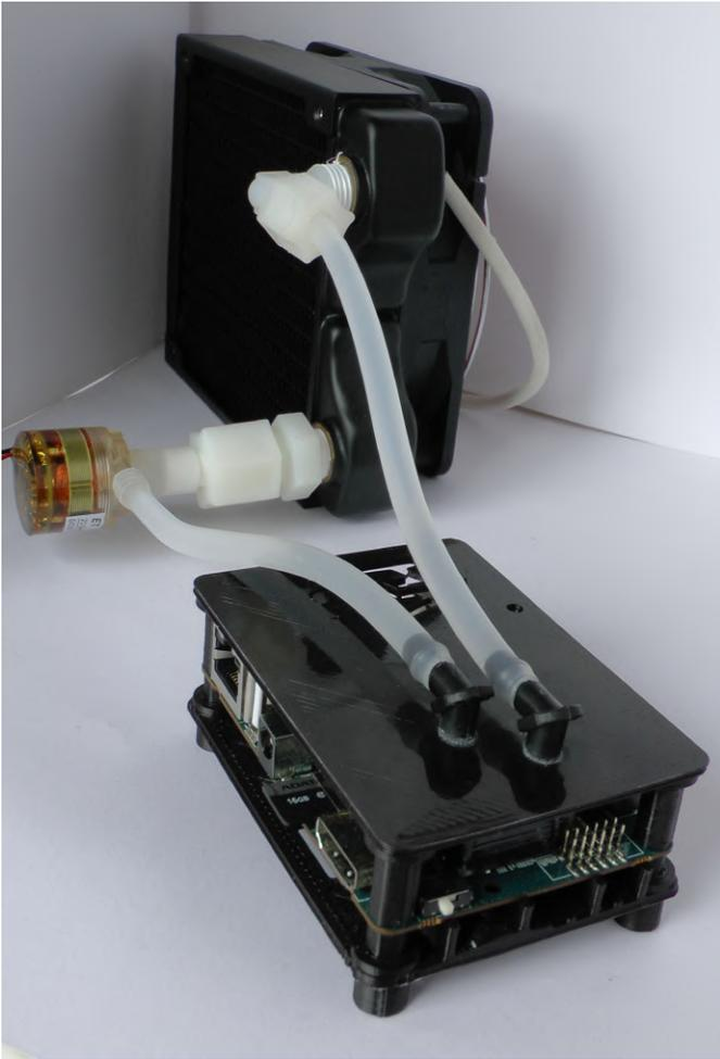
Figura 5 - Banco de pruebas del bloque de agua
