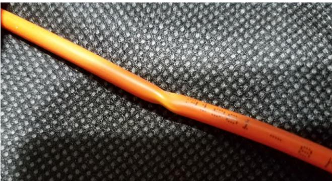
**Figura 14 - Cable mal doblado**
