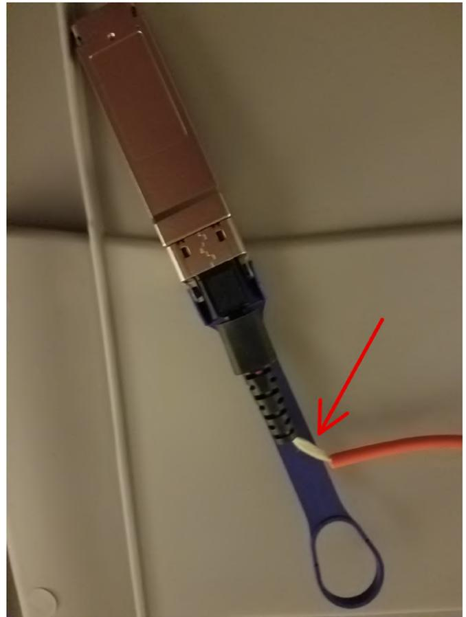
**Figura 15: Alguien tiró del cable para desconectarlo en lugar de usar la pestaña de extracción. Este cable está muerto y es irreparable.**
