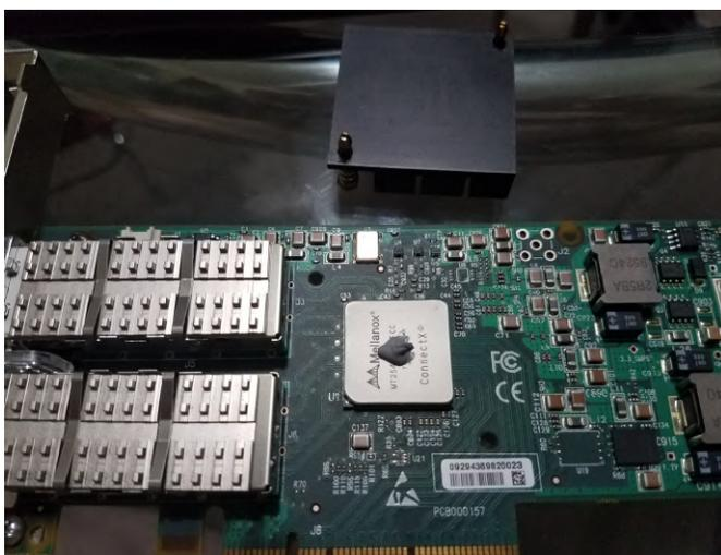
**Figura 19: Añadiendo una gota de compuesto térmico, suficiente pero no excesiva**
