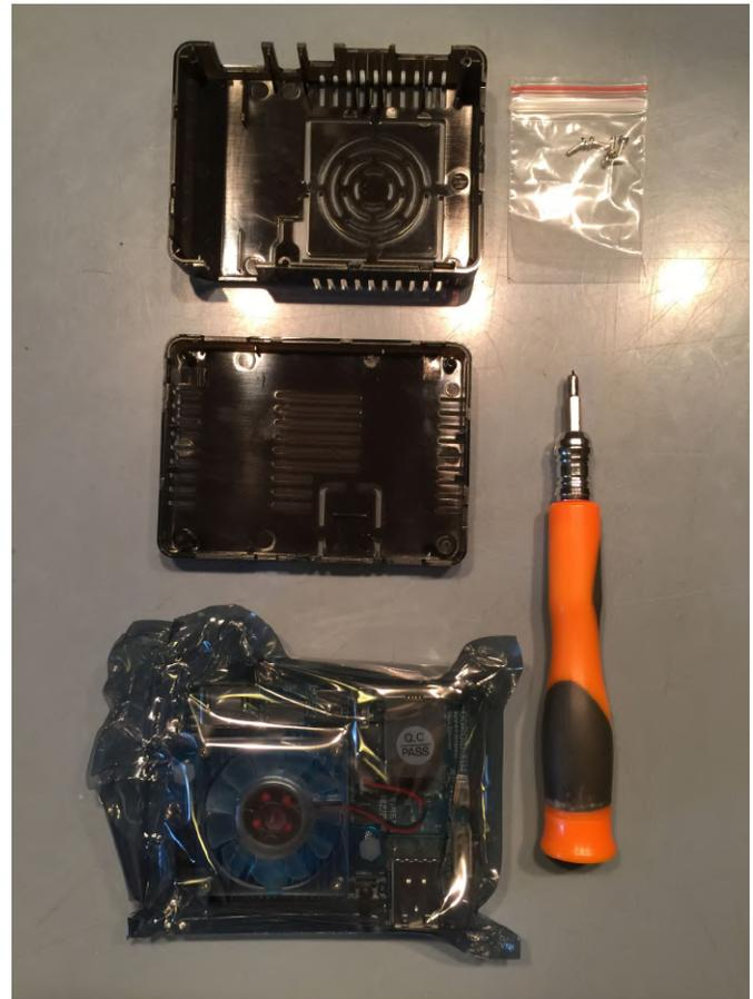
**Figura 6: Herramientas y componentes para el ensamblaje de la carcasa**
