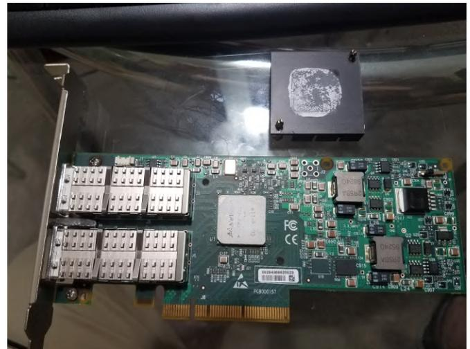
**Figura 17 - Disipador térmico con remaches de latón**
