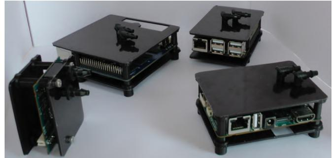
**Figura 4 - Carcasas ODROID refrigeradas por agua (MC1, N1, C2 y XU4)**
