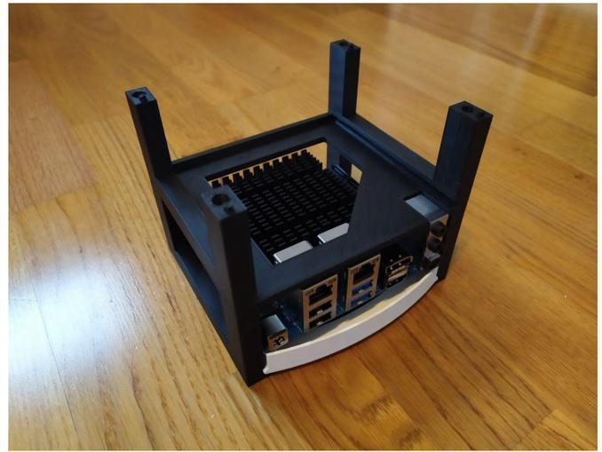
Figura 18: La segunda impresión de montaje, donde las agarraderas de alineación funcionan muy bien, aunque los agujeros deben limpiarse de plástico para que puedan hacer su trabajo correctamente.
