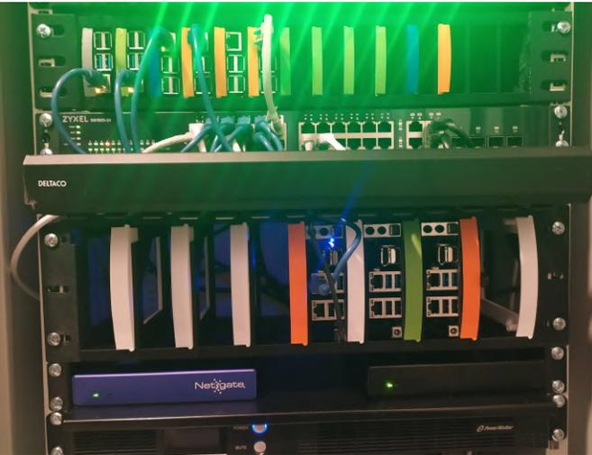
**Figura 22: el conjunto final montado en un bastidor, con 3 unidades ODROID-H2 instaladas**
