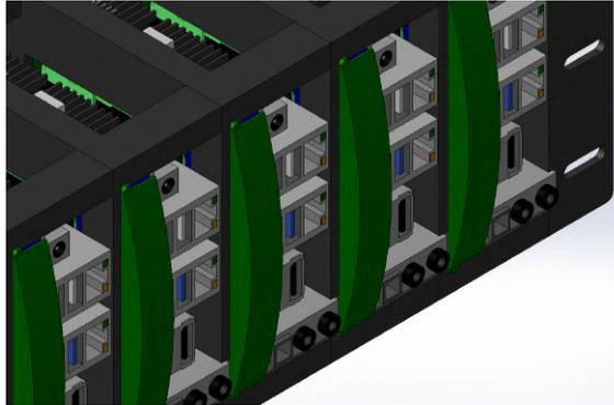
Figura 13: Aquí puedes ver cómo cada conector de audio se integra en el siguiente bloque, ahorrando espacio para permitir 8 unidades en 3U
