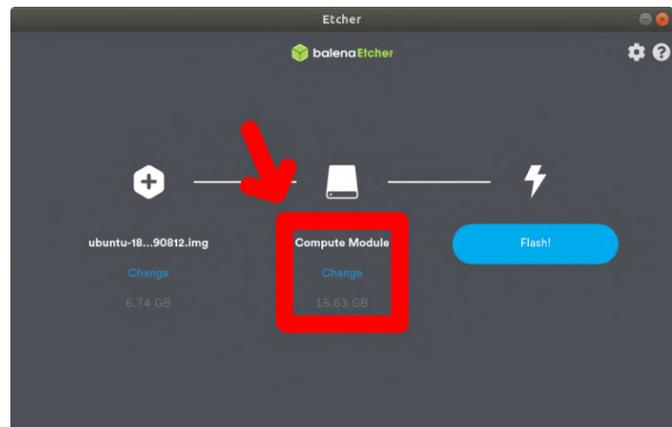
Figure 7 - Usa Etcher para escribir la imagen del sistema operativo en el N2
