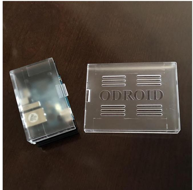
**Figura 2:** Únicamente necesitas la mitad de la carcasa transparente ODROID-HC1 para proteger tu ODROID-MC1 Solo.
