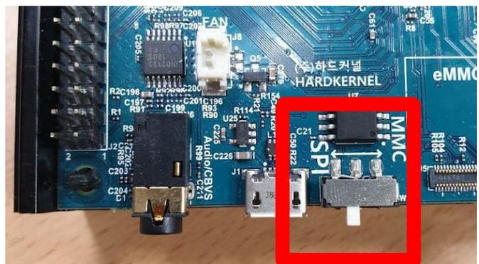
Figura 1 - Cambiando el arranque al modo SPI
