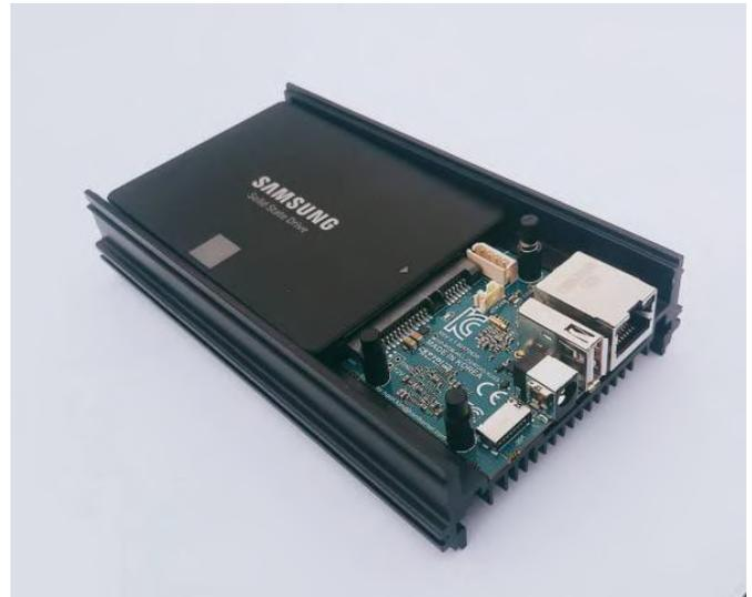
**Figura 6:** El nodo de compilación de destino de ejemplo es un ODROID-HC1
