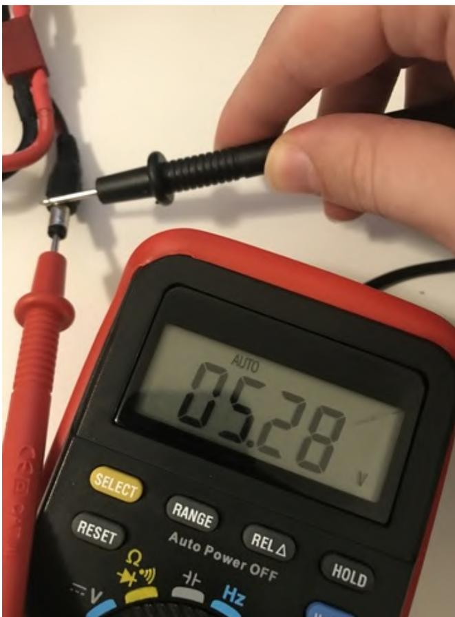
Figura 7 - Salida de voltaje del BEC tras encender el circuito
