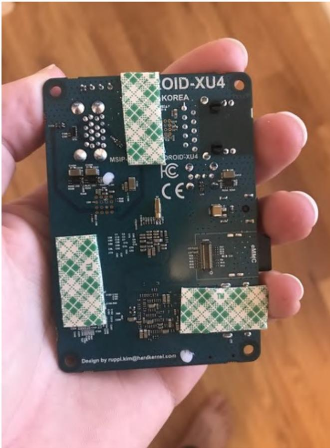
Figura 9 - Montaje de la cinta de doble cara por debajo del ODR0ID-XU4
