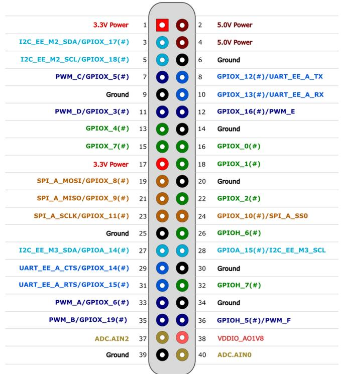
Figura 16 - cabezal GPIO
