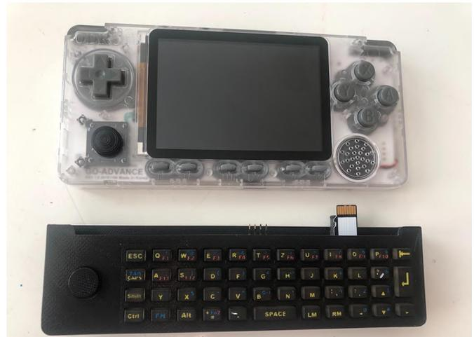
**Figura 10 - Teclado no conectado, que muestra la extensión microSD**
