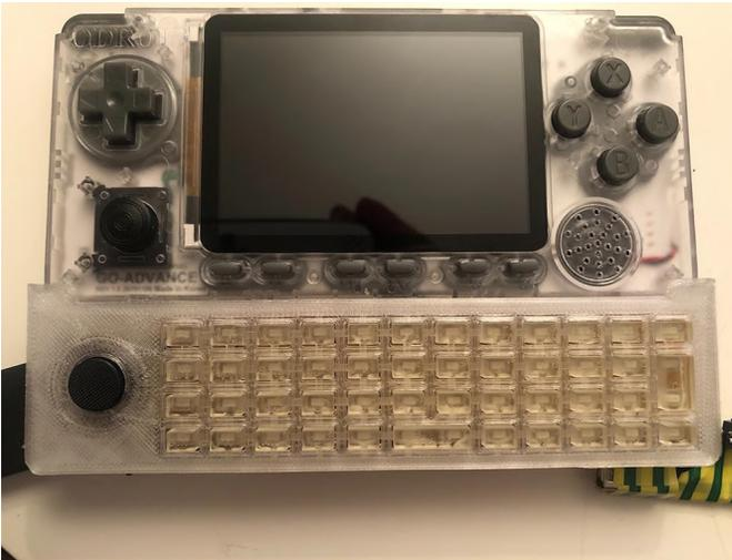
**Figura 6 - Carcasa prototipo**
