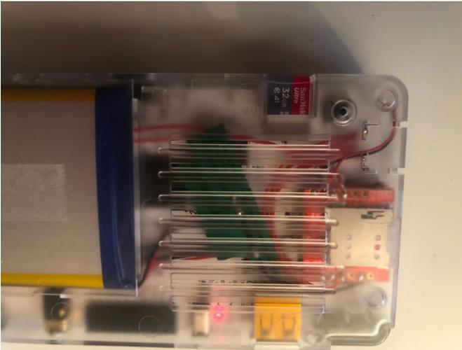
Figura 3 - Tarjeta SIM800L y antena
