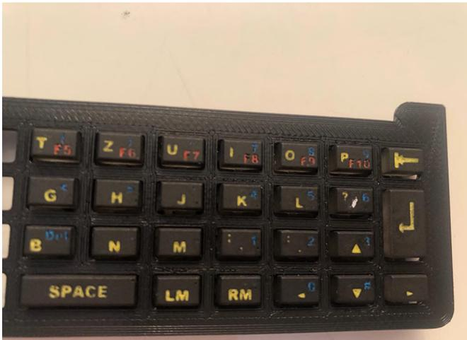
**Figura 9 - Nueva carcasa con las teclas insertadas**
