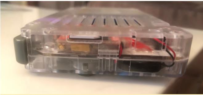
Figura 2 - Vista lateral con recorte para SIM800L
