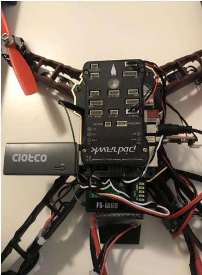
Figura 12 - Receptor, conector, USB-TTL, adaptador WiFi y salidas ESC conectadas
