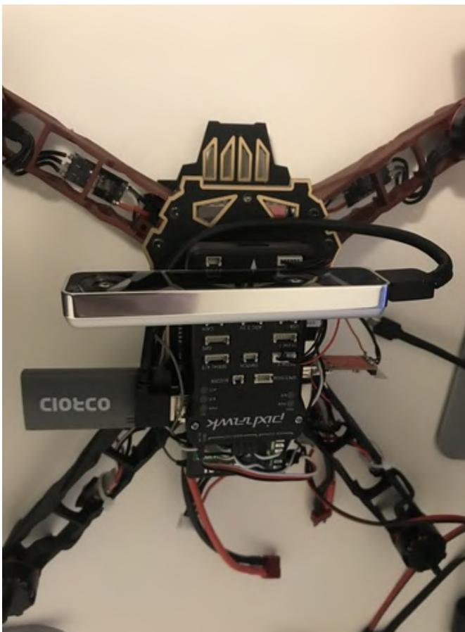
Figura 13: Cámara Realsense T265 montada en la parte superior de Pixhawk FCU y conectada al ODROID
