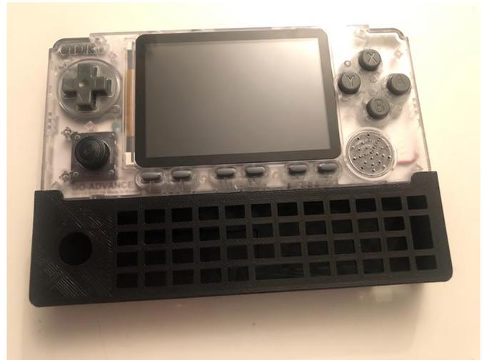
**Figura 8 - Segunda impresión de la carcasa**
