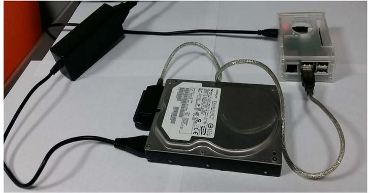
Disco duro externo conectado a la Raspberry Pi 3
