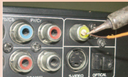
Figura 3. El cautín calienta el alambre y este penetra en el plástico.
