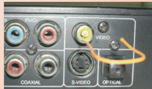
Figura 4. El extremo del alambre quedó incrustado el plástico de la punta a extraer.
