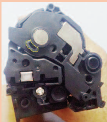
Fig. 4: Vista izquierda. Remover con una cuchilla la parte señalada
