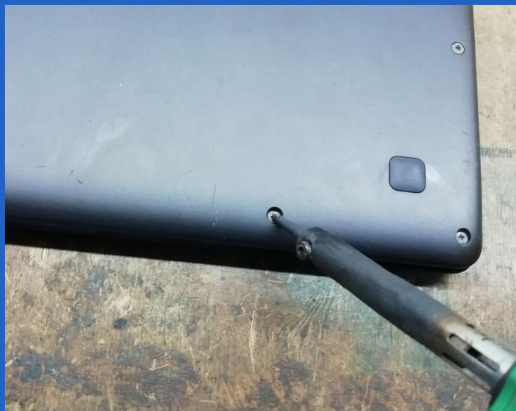
Fig 1. Aplicando calor al tornillo resistente mediante un cautín.
