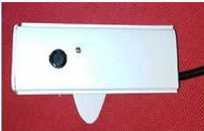
Fig. 2. Módulo de la cámara web dentro de un contenedor de protección
