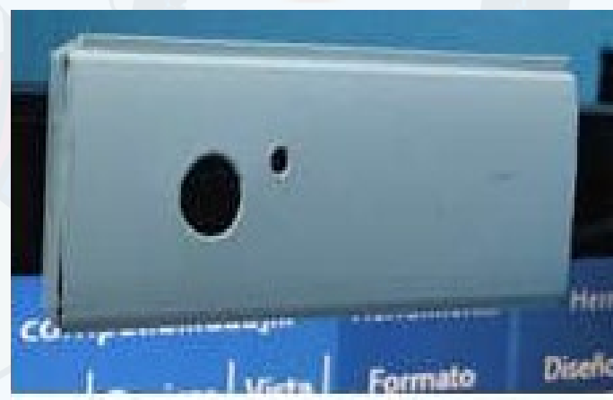
Fig. 5. Cámara web reciclada de una laptop y acondicionada a una PC
